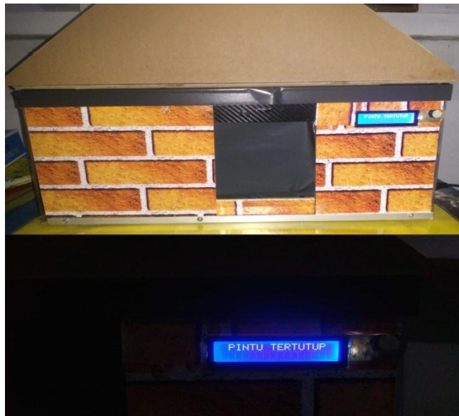
Gambar 3. 15 Pengujian pintu tertutup dan data lcd
