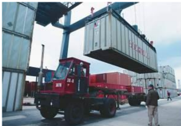
Gambar 3. Alat pengangkat peti kemas di pelabuhan menggunakan prinsip katrol bebas
