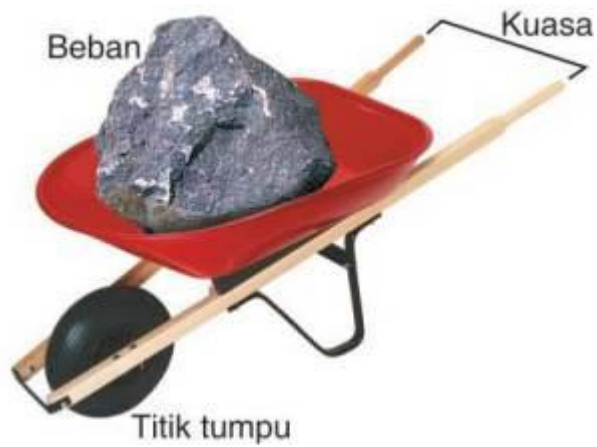
Gambar 5. letak titik tumpu, beban, dan kuasa pada gerobak roda satu
