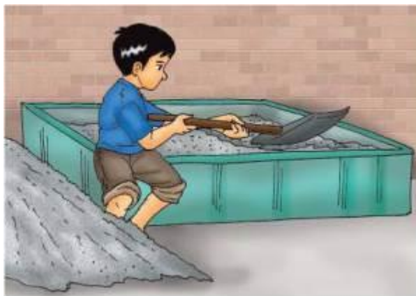
Gambar 6. Sekop adalah contoh tuas golongan ketiga
