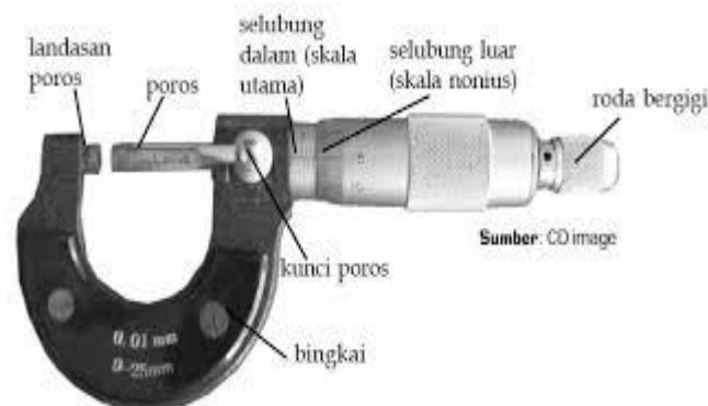
Gambar 3. Bagian-bagian Mikrometer Sekrup
