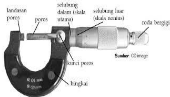
Gambar 3. Bagian-bagian Mikrometer Sekrup
